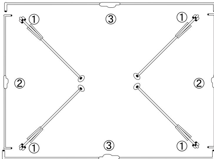
(3) 鉄骨を組みます。角柱(①)にある3つの穴のうち、左右にある穴に梁(②・③)を差し込み、土台を組みます。その後合掌(④)を棟(⑤)に差し込んでから、角柱(①)の一番外側に差し込みます。
