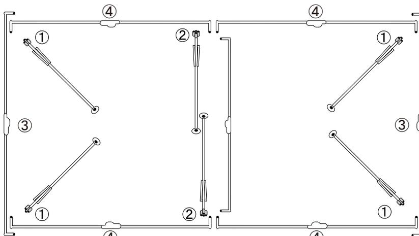
(3) 鉄骨を組みます。柱 (①・②) にある3つもしくは4つある穴のうち、左右にある穴に梁 (③・④) を差し込み、土台を組みます。鉄骨を組みます。角柱 (①) にある3つの穴のうち、左右にある穴に梁 (③・④) を差し込み、土台を組みます。その後合掌 (⑤) を棟 (⑥) に差し込んでから、角柱 (①) の一番外側に差し込みます。
